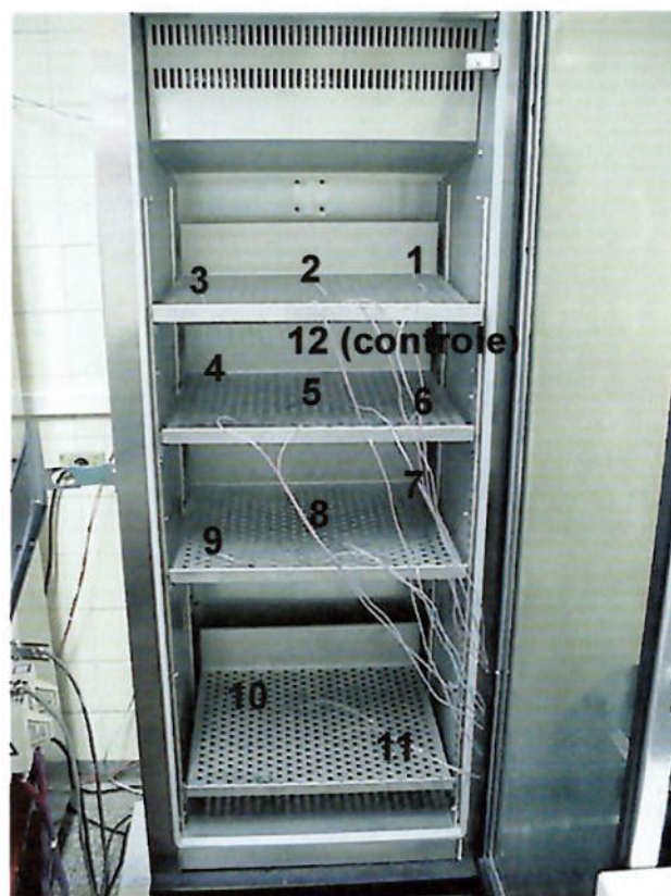
Figura 5 – Posição dos sensores de medição de temperatura (sem carga)
