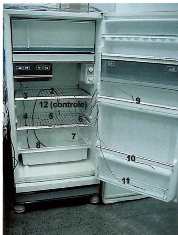
Figura 7 – Posição dos sensores de medição de temperatura (sem carga)
